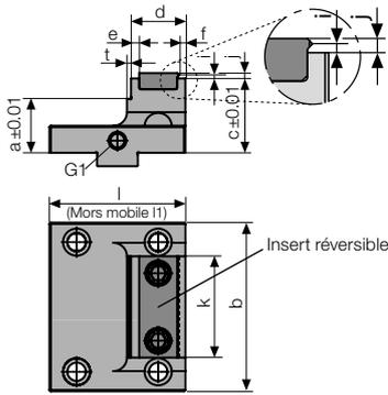
**Système puissant avec insert de serrage grip, différentes largeurs**
