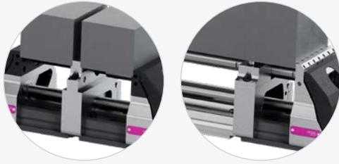
Tiges de traction et écrous de serrage pour largeurs de serrage 0 - 200 mm fournis
