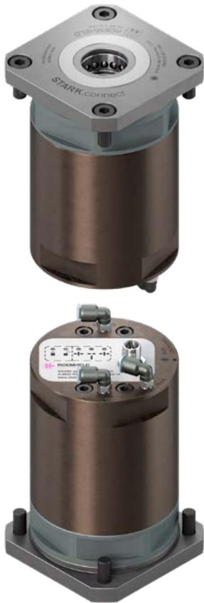
Module de serrage rapide en acier à outils de haute qualité ou en aluminium anodisé dur. Le système est pneumatique à simple effet (serrage par ressort) avec verrouillage (fonction LOCK) et un renforcement pneumatique de la force de serrage en option.
