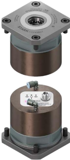
Module de serrage rapide en acier à outils de haute qualité ou en aluminium anodisé dur. Le système est pneumatique à simple effet (serrage par ressort) ainsi qu'un renforcement pneumatique de la force de serrage en option.
