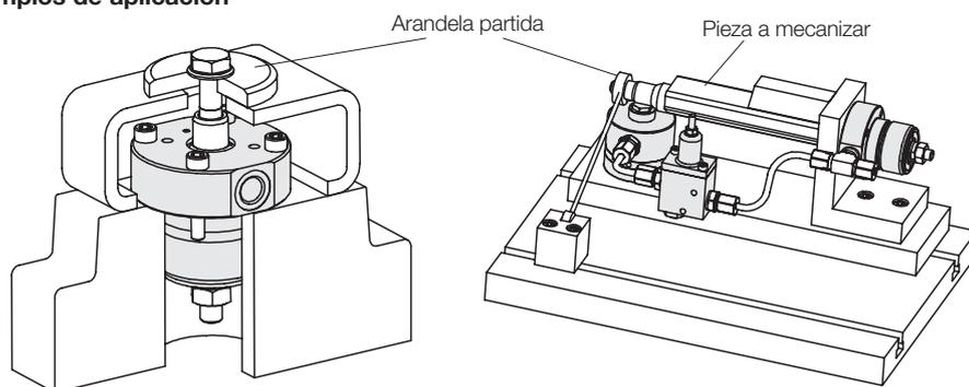
Muy a menudo resulta posible sujetar de modo racional piezas con agujeros pasantes mediante cilindros de vástago hueco, combinados con tirantes y arandelas partidas.
