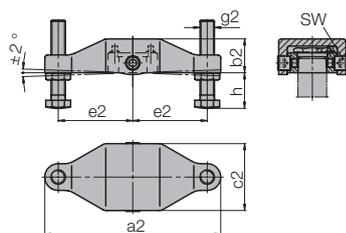
Soporte para brida de sujeción doble 42CrV4 bonificado
