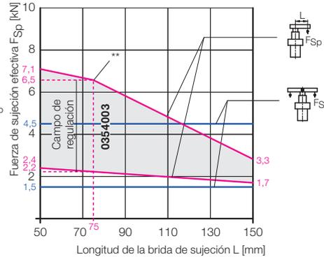
\*\* Con longitudes de brida de sujeción > 75 mm, tener en cuenta los parámetros de ajuste permitidos de la fuerza de sujeción efectiva según las instrucciones de servicio.
