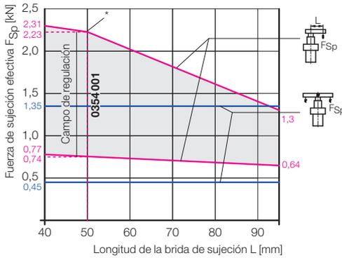
\* Con longitudes de brida de sujeción > 50 mm, tener en cuenta los parámetros de ajuste permitidos de la fuerza de sujeción efectiva según las instrucciones de servicio.
