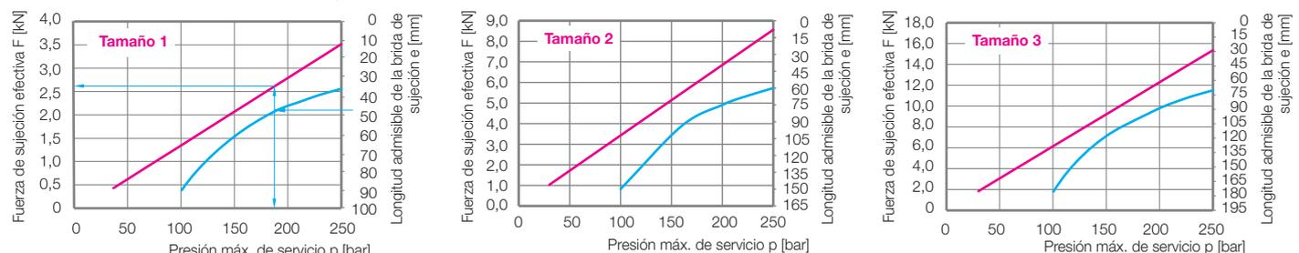
**Ejemplo:** Longitud de la brida de sujeción 47 mm, presión máx. de servicio 187 bar, fuerza de sujeción efectiva 2,6 kN
