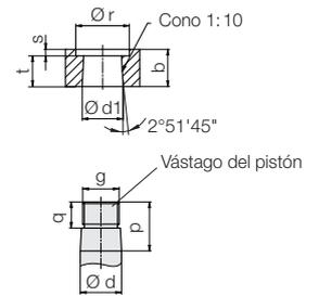
En la pieza bruta de brida de sujeción está incorporado el asiento cónico con la precisión necesaria. La adaptación a los puntos de sujeción de la pieza de trabajo tiene lugar mediante:
