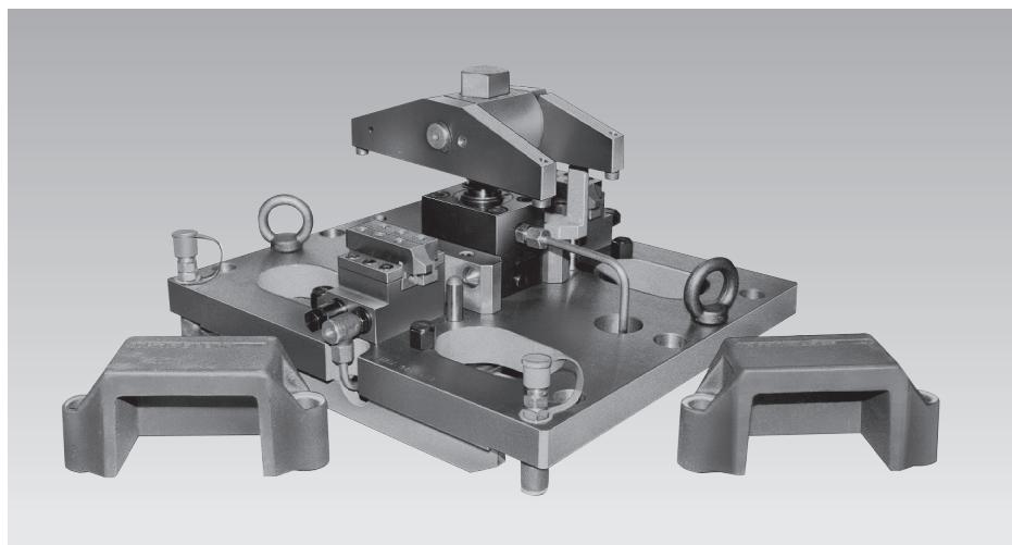
Le montage de serrage avec plaque de base est utilisé sur un centre d'usinage vertical avec table indexage et palier tournant.
