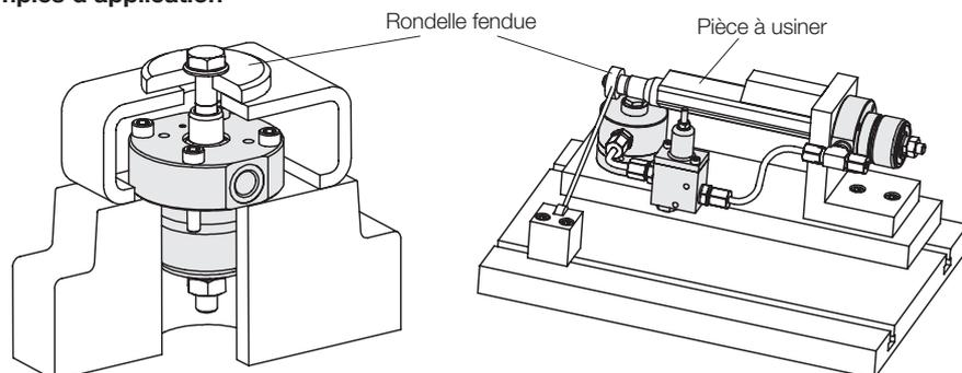
Les vérins à piston creux, équipés avec des tirants et des rondelles fendues, permettent le serrage rationnel de pièces à trous débouchants.
