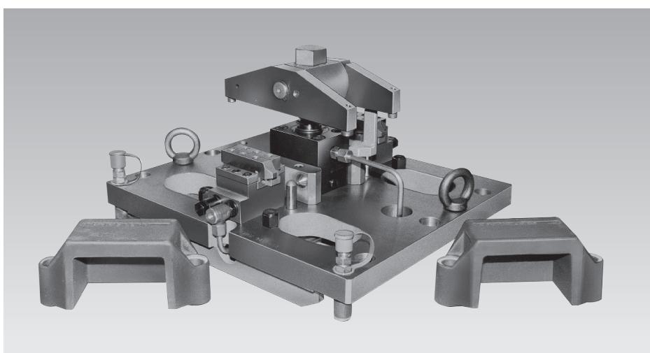
El útil de sujeción de construcción con placas se utiliza en un centro de mecanizado vertical con dispositivo de volteo de pieza y soporte de apoyo.
