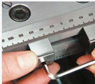
2. Régler les bords extérieurs des inserts env. 2 mm au-dessous de la dimension finie.
